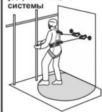
Рис. 15. Способ организации удерживающей системы
