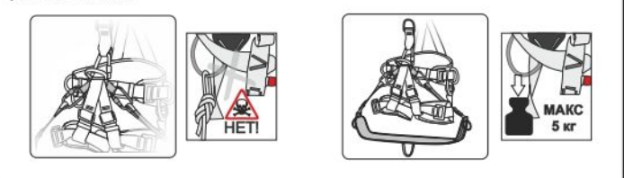
Рис. 18. Способ интеграции рабочего сидения
