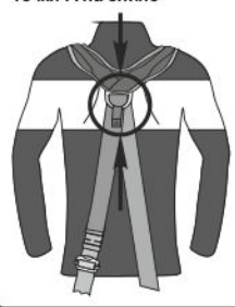
Рис. 10. Правильное положение страховочной точки А на спине
