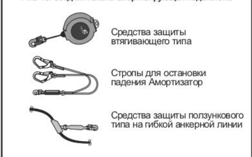
Рис. 15. Способ организации удерживающей системы
