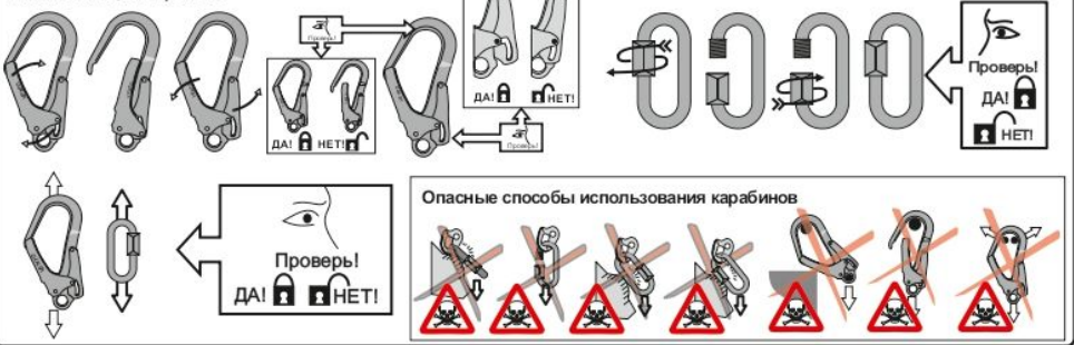
Рис. 7. Способы крепления стропов к анкерным устройствам
