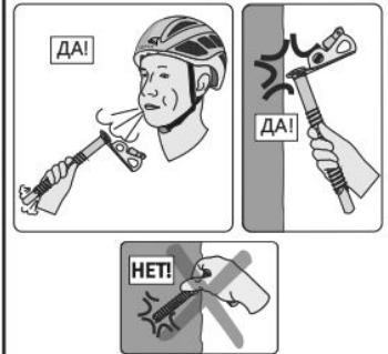
Рис. 10. Очистка ледобура от керна
