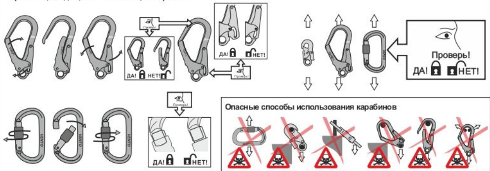
Рис. 6. Способы крепления стропов к анкерным устройствам
