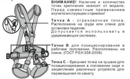
Рис. 3. Расположение и назначение крепежных точек на привязях
