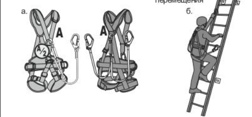
Рис. 4. В страховочных системах допускается использование только стропы с амортизатором рывка
