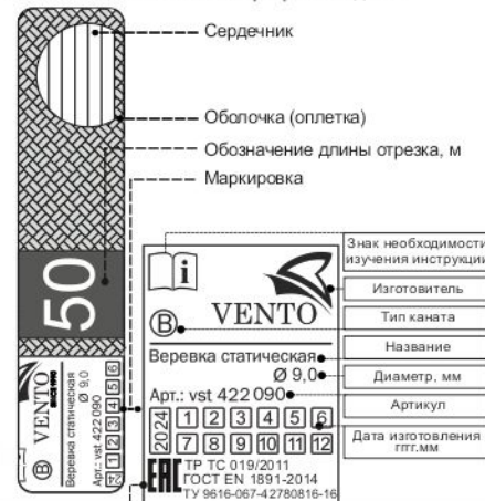
Рис. 1. Составные части и маркировка изделия
