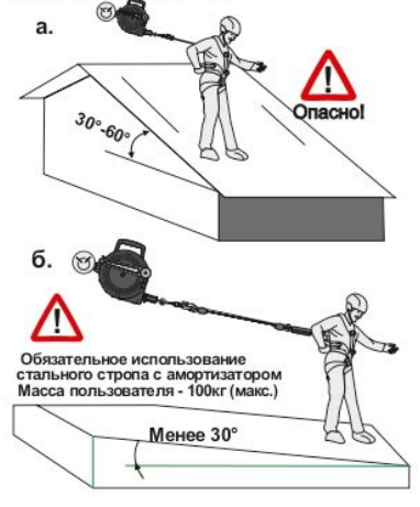
Рис. 9. Использование на горизонтальных и наклонных поверхностях
