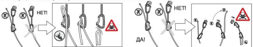
Рис. 4. Прощекивание веревки при использовании скалолазных оттяжек
