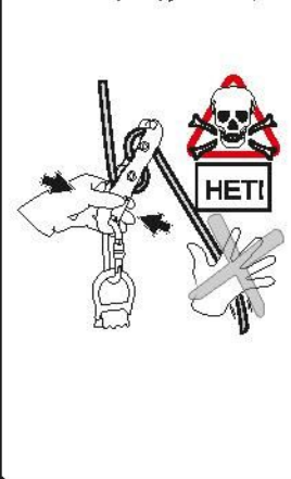
Рис. 13. Подъем с использованием зажима со стремнем
