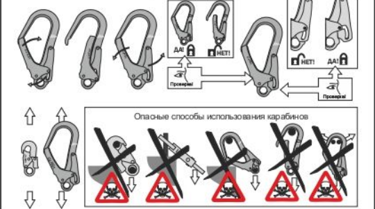
Рис. 8. Ограничения по использованию стропов с амортизатором
