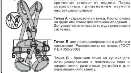
Рис. 5. Способы крепления к анкерным устройствам
