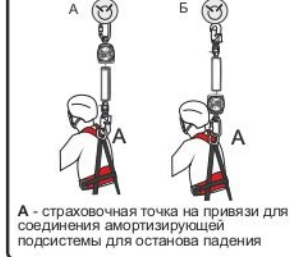
Рис. 5. Общие принципы использования карабинов
