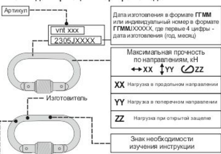
Рис. 2. Идентификация и маркировка изделия
