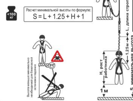
Рис. 9. Способы крепления к анкерным устройствам
